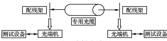
图 2 实例测试框图
