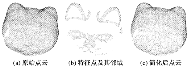
图 5 猫头模型点云简化结果
