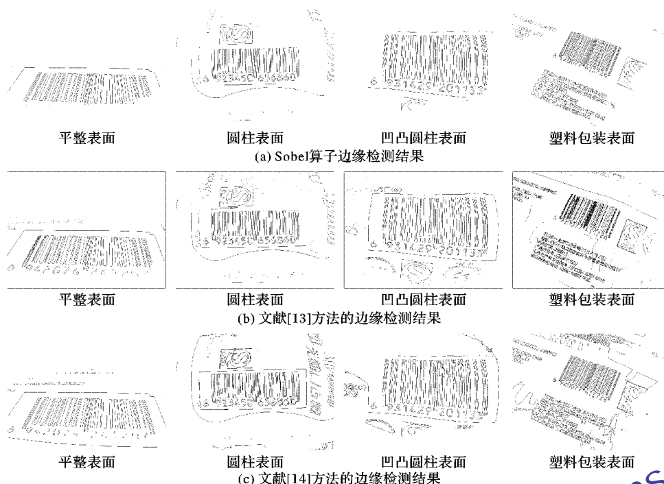
图9 Sobel算子及其改进算法对常见商品条形码提取边缘线效果图
