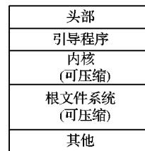
图1 嵌入式操作系统固件主要结构
