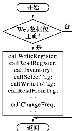
图10 读写器固件程序接收处理 Web 命令流程
