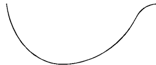
图11 螺杆压缩机阴转子型线
