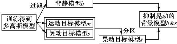
图1 晃动抑制原理
