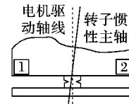
图4 陀螺转子惯性主轴与驱动轴线不重合
